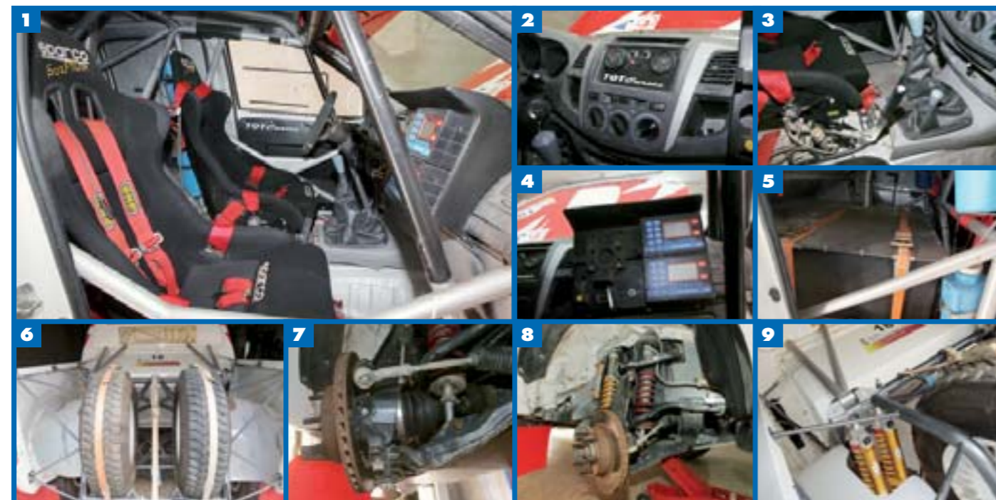
El habitáculo (1) del Hilux KXR acomoda a sus dos ocupantes en sendos buckets Sparco Evolution con arneses y protegidos bajo un arco de seguridad multipunto. En el centro del tablier se sitúa el manómetro de presión del turbo (2), bien a la vista de la zona reservada al copiloto (4). Más abajo, la palanca del cambio, la transfer y el freno de mano (3). A espaldas de piloto y copiloto se ubica el depósito de carburante (5), de 330 litros. La zaga reserva espacio para tres ruedas de repuesto en una estructura modificada (6) para hacer entrar el conjunto de doble amortiguador Öhlins (9) con muelle y botella separada. Delante, idéntica combinación con resortes helicoidales con tarados distintos (8) y manguetas reconstruidas (7).
